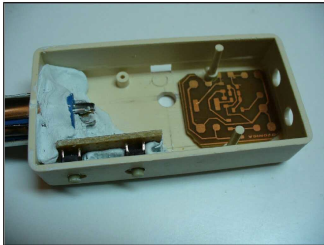
Figura 7 – Disposição das peças sem o Bluetooth
