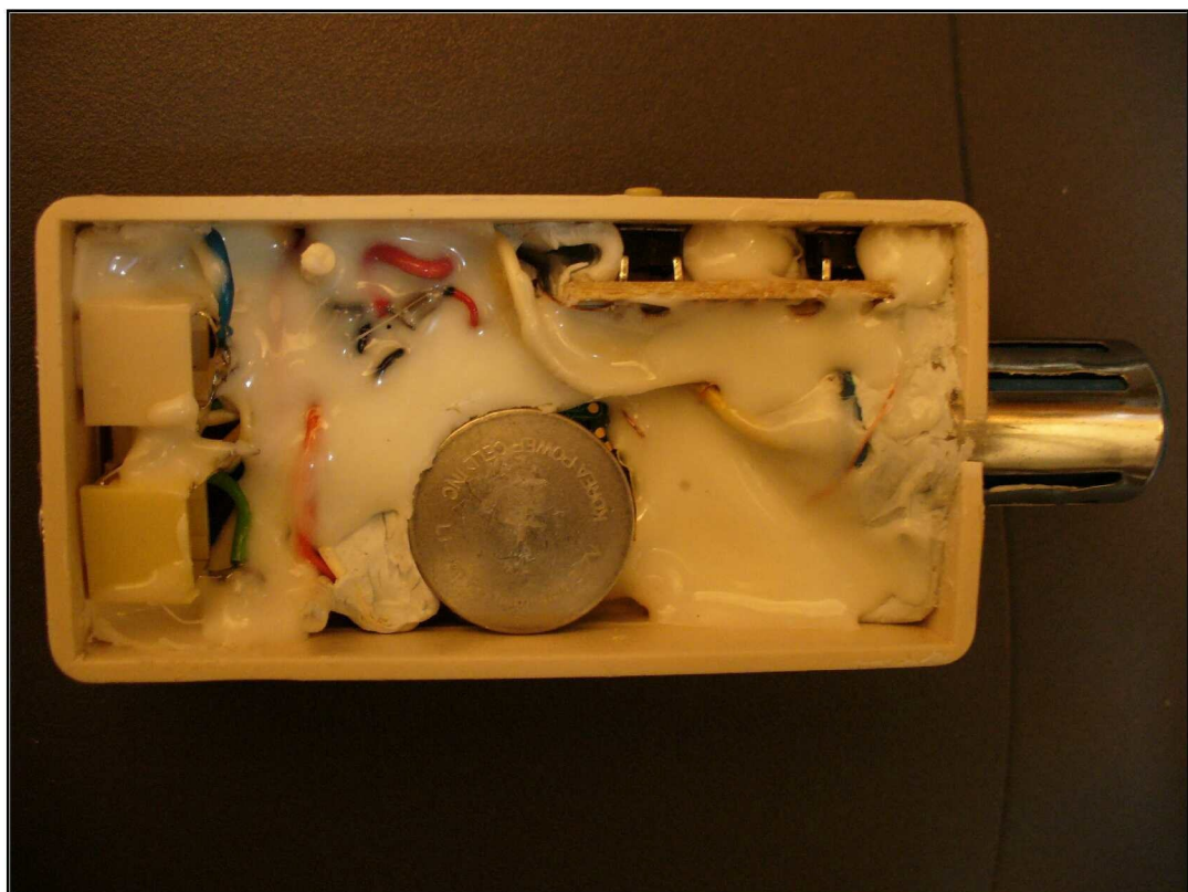
Figura 10 – Caixa cheia a cola endurecida.
