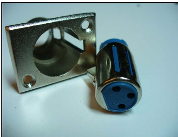
Figura 2 – Canhão da ficha XLR retirado
