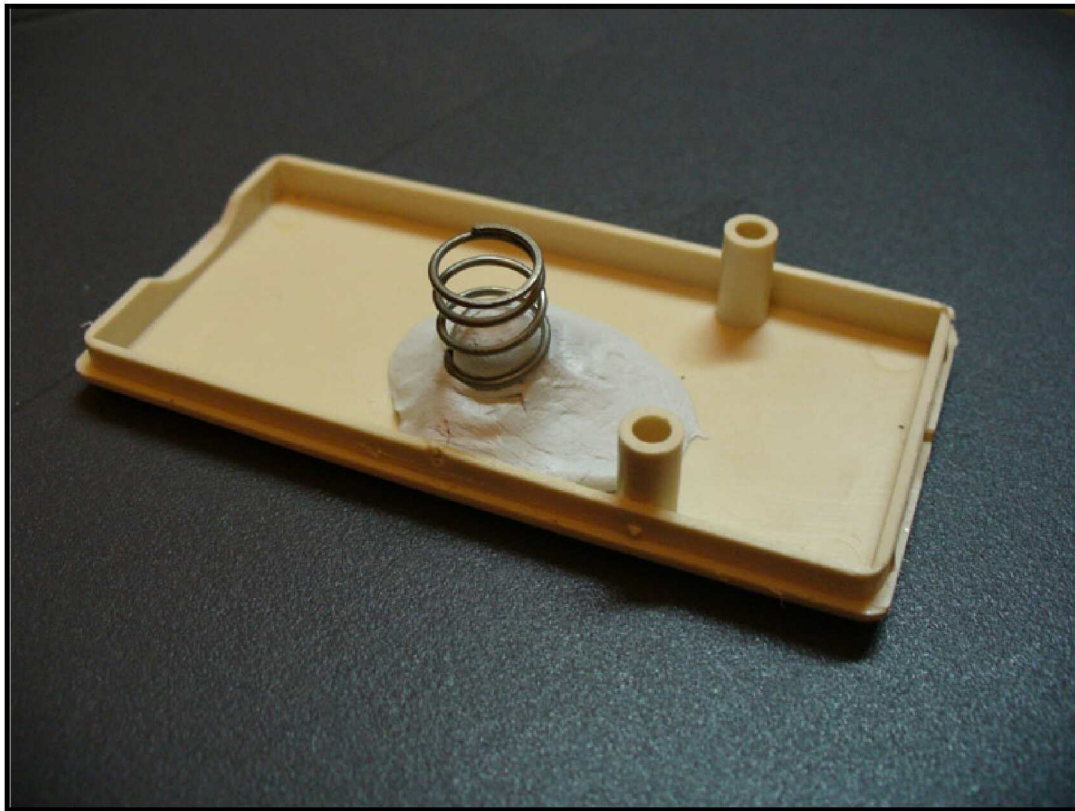
Figura 9- Mola de pressão para bateria de Lítio
