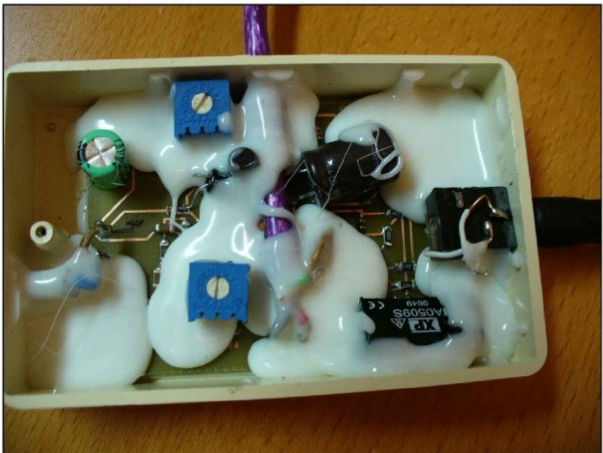
A Unidade após o enchimento de cola quente para conferir robustez e consistência
